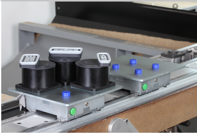
Адаптерные плиты ISAP-B с монобазой и присосками для зажима деревянных компонентов
